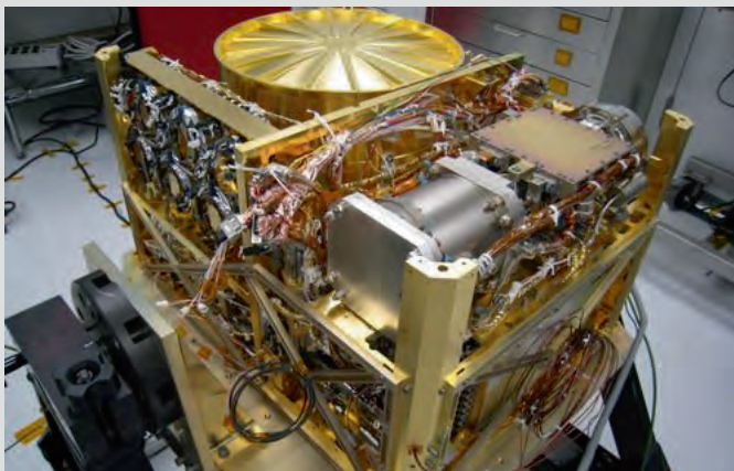
SAM, apparatet som måler metanmengden i Mars-atmosfæren. Bilde: NASA-GSFC
