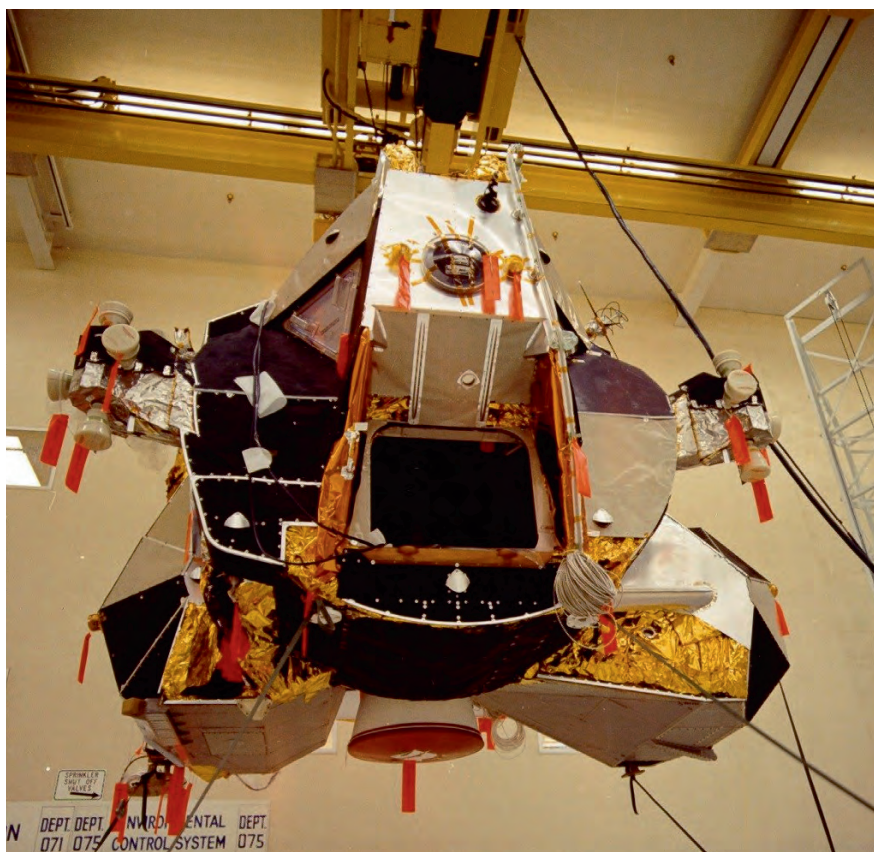
Mannskapsmodulen til månelandingsfartøyet Eagle med plass til to astronauter ankom Cape Kennedy 8. januar 1969 fra produsenten Grumman Aircraft Engineering Company. Massen til dette oppstigningstrinnet var drøye 4,5 tonn. Hele månelandingsfartøyet støtt plassert på Månens overflate hadde en masse på drøye 14,6 tonn. Høyden inklusive de fire landingsføttene utslått var 6,3 meter. FOTO: NASA, skannet av Kipp Teague.
